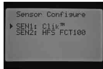
SEN 1 – Klik-Sensoren SEN 2 – Durchflusssensor (HFS FCT100)
